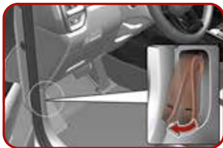
Motorhaube [4] Ziehen Sie den Entriegelungshebel, um die Motorhaube zu entriegeln.
