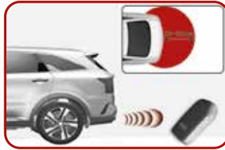
Die intelligente Heckklappe lässt ein Begrüßungssignal ertönen, wenn der Smart-Key innerhalb von 50 – 100 cm entfernt ist.
