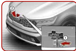
Heben Sie die Motorhaube leicht an, drücken Sie den Entriegelungshebel der zweiten Verriegelungsstufe (1) nach links und klappen Sie die Motorhaube (2) hoch.
