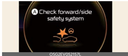
A: Vordere/seitliche Sicherheitssysteme überprüfen
